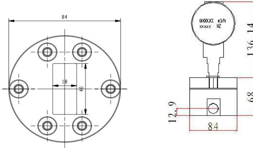
图 5 DN15-DN20 安装尺寸图
